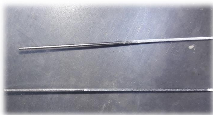
Figura 12: Depósito de óxido de nióbio no grafite.
