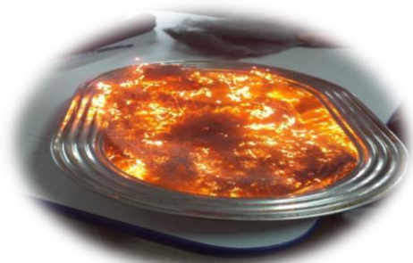
Figura 13: Queima da palha de aço.
