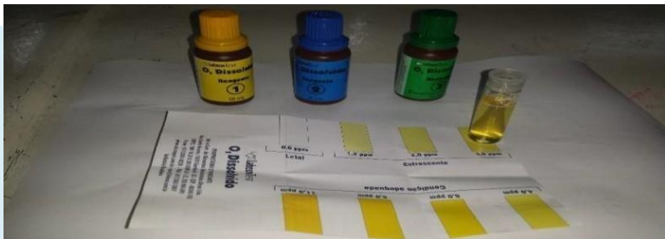
Figura 21 - Medindo o Oxigênio Dissolvido na água Fonte: A autora
