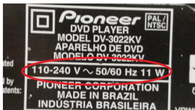
Foto 8 - Especificações de aparelhos elétricos/eletrônicos
