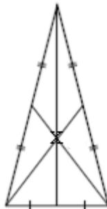
Figura 15; Determinando o *CG* de um triângulo.
