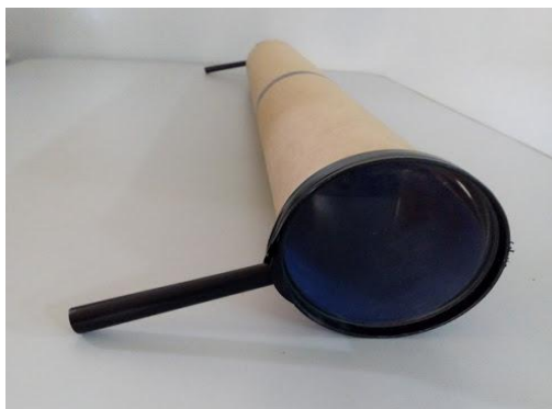
Figura 17: Luneta construída durante a formação.
