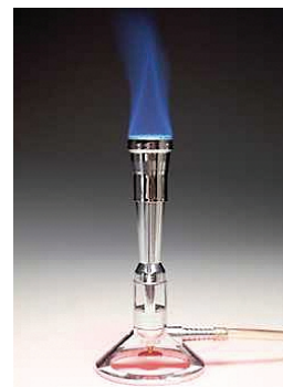
Figura 1: No bico de Bunsen, o combustível (GLP, por exemplo) e o comburente ( O_2 ) são previamente misturados, o que leva a uma chama mais quente e livre de fuligem.
