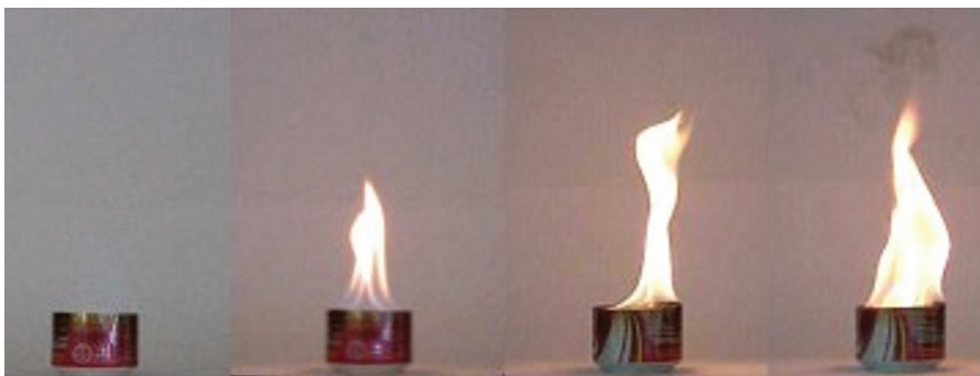
Figura 5: Chamas de difusão obtidas utilizando metanol, etanol, álcool tert -butílico e butan-1-ol, respectivamente.
