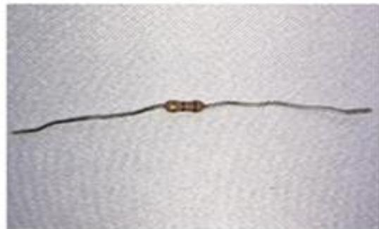
Figura 2 – Um resistor de cerâmica
