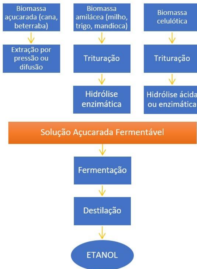
Figura 73 – Esquema das vias de extração de três diferentes biomassas (açúcar, amido e celulose) para obtenção de etanol. Fonte: as autoras
