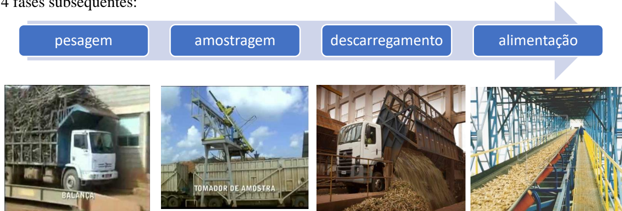
Figura 54 – Fases de processamento da cana-de-açúcar após chegar à usina. Fonte: http://www.encontracarros.com/tag/preco-do-alcool/
