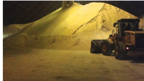
Figura 64 – Silo de fundo plano com armazenagem de açúcar a granel.
