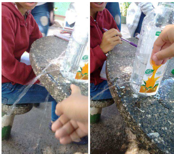
Figura 13: Experimentos Fase 2 (Influência da diferença de pressão sobre a velocidade e alcance - Garrafa de plástico furada com água dentro) Fonte: Autoria própria, 2018.
