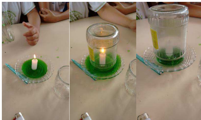
Figura 03: Experimentos Fase 1 (Variação de pressão - Vela no prato com água) Fonte: Autoria própria, 2018.
