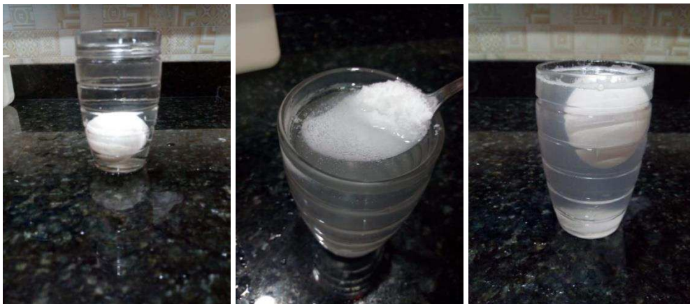
Figura 05: Experimentos Fase 1 (Densidade de massa - ovo boiando na água com sal e na água sem sal)
