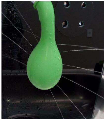
Figura 09: Experimentos Fase 1 (Influência da diferença de pressão sobre a velocidade - balão cheio de água com furos – equação de Bernoulli ou “xixi de Torricelli”) Fonte: Autoria própria, 2018.
