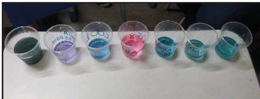
Figura 5: Observação da coloração das substâncias, em uma escala com indicador de pH. Fonte: Autoria própria, 2017
