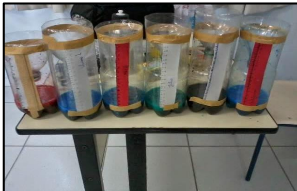
Figura 46: pluviômetros construído pelos alunos
