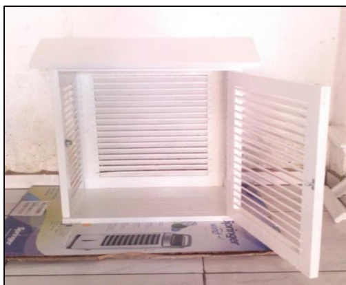
Figura 28: Abrigo Meteorológico em construção Fonte: Arquivo pessoal
