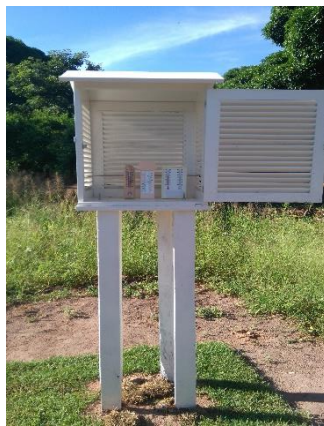
Figura 30: abrigo meteorológico e os equipamentos Fonte: arquivo pessoal
