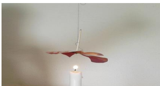
Figura 33: cata vento: propagação do calor por convecção
