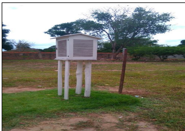
Figura 42: Abrigo Meteorológico Fonte: arquivo da pesquisadora
