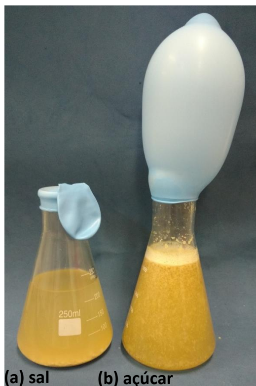
Figura 2. Comparação entre a utilização de (a) sal e (b) açúcar para o processo de fermentação alcoólica.
