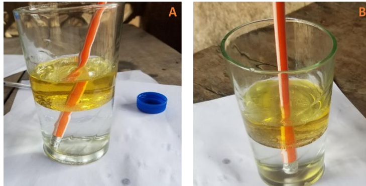
Figura 5. Experiência 2: análise do índice de refração em três meios diferentes, o ar, o óleo e a água, com: A: incidência oblíqua. B: Incidência perpendicularmente à superfície.
