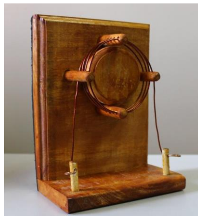
Figura 5 - Modelo do Multiplicador de Poggendorff
