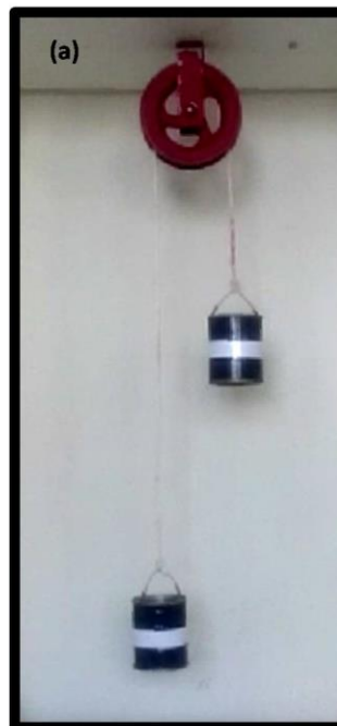
Figura A1: Aparato experimental-Máquina de Atwood. Fonte: Autores.
