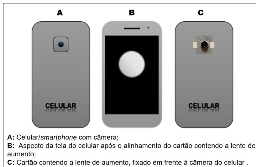
Figura 11: Esquema de como posicionar o cartão com a lente alinhada à câmera do celular (sequência A, B e C). Fonte: SOUZA, (2020).
