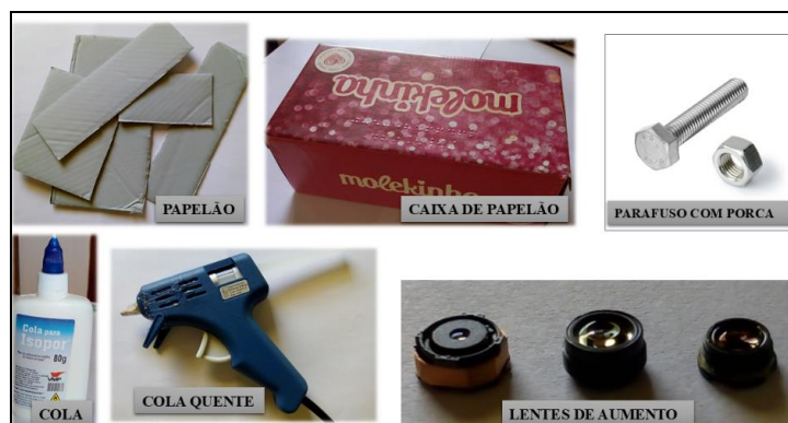
Figura 2: Materiais utilizados na construção do modelo de microscópio alternativo. Fonte: SOUZA, (2020).
