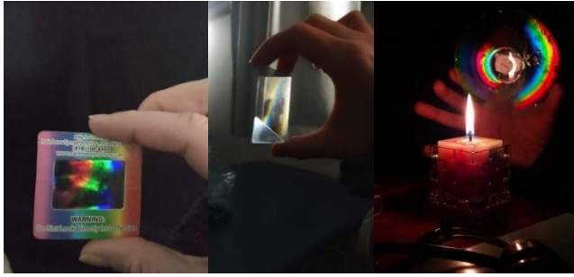
Figura 6 - Experimentos prismático de refração e dispersão da luz
