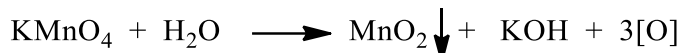
Figura 5. Equação que representa o uso do permanganato de potássio em oxidação branda de alquenos (Fonte: Os Autores)
