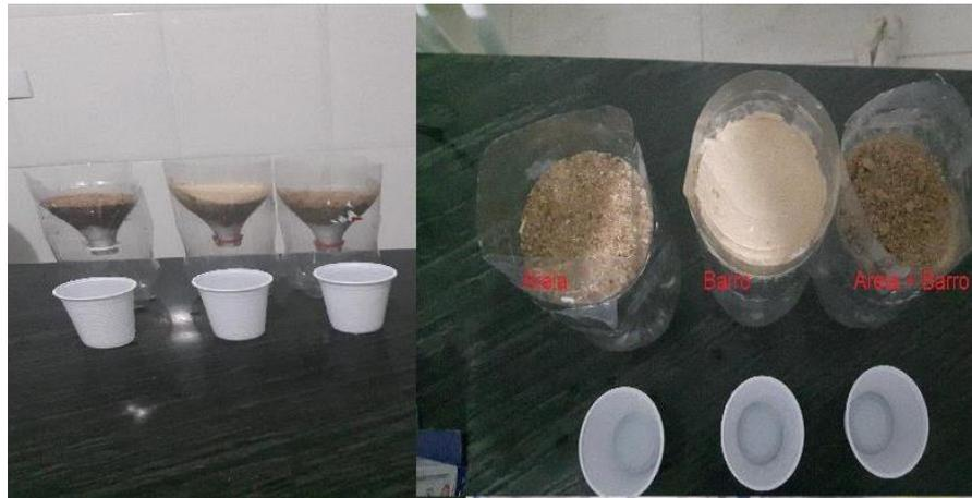
**Figura 2:** Montagem dos filtros e os tipos de solo utilizados.
