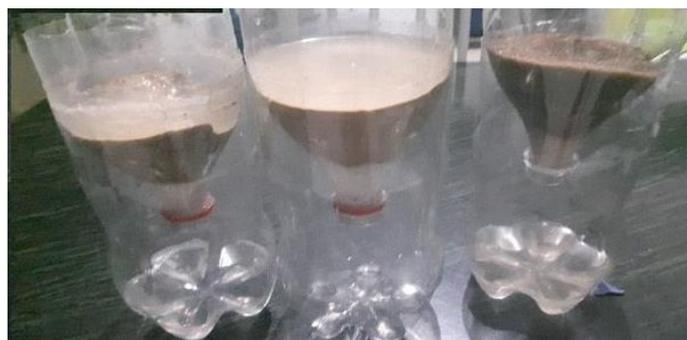
**Figura 4:** Água no fundo da garrafa (usadas como filtro) após pararem pelos diferentes solos.
