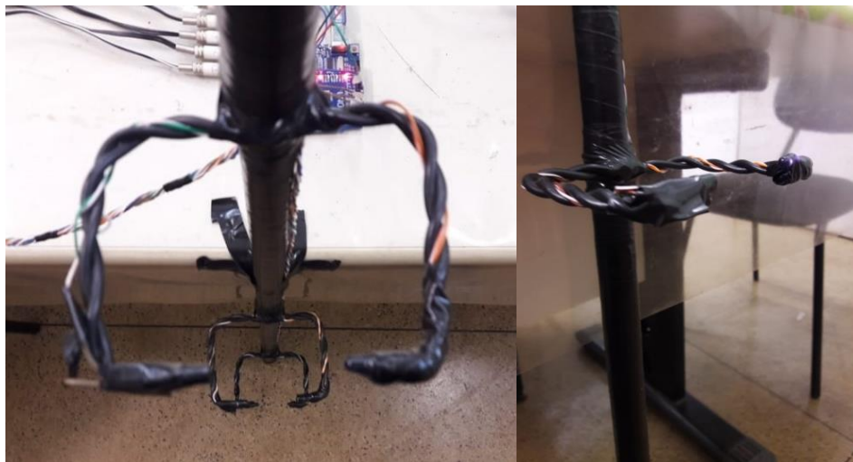
Figura 4 - Forquilhas com pares emissores-sensores infravermelho. Fonte: Elaborado pelos autores (2020).
