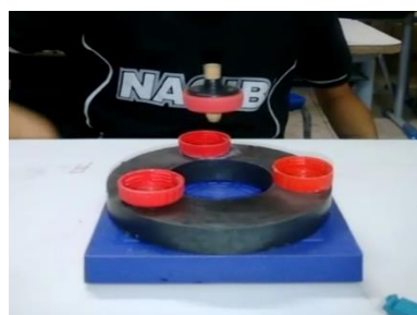
Figura 1: Brinquedo científico (pião de levitação magnética)
