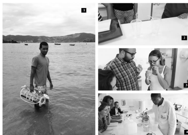
Figura 1 Etapas do processo descrito. 1- coleta da água, 2- preparo do material, 3- insuflação e 4- análises.
