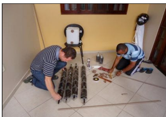
Figura 5: aquecedor solar caseiro.
