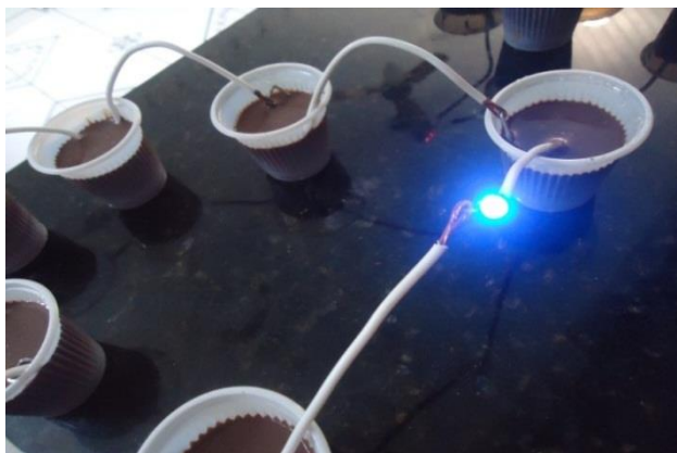
Figura 7: Para que a lâmpada permaneça ligada é preciso que o fio interligado conduza a corrente elétrica a partir do processo da eletrólise.
