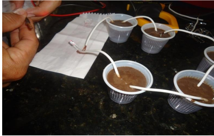
Figura 10: Montagem de um circuito elétrico simples para a verificação do processo de eletrolise com intuito de acender uma lâmpada de led.
