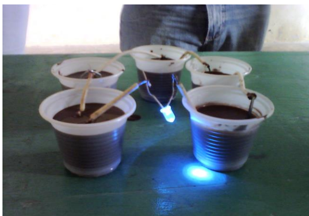
Figura 9: aparecimento de corrente elétrica num circuito em serie de suco grosso de açaí azedo.
