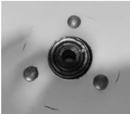
Figura 4: Rolamento fixo na base
