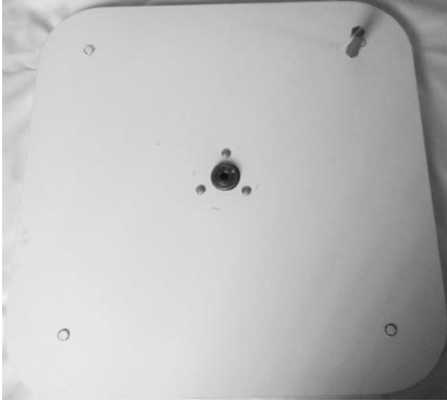
Figura 2: Base - parte de cima (já com o rolamento)
