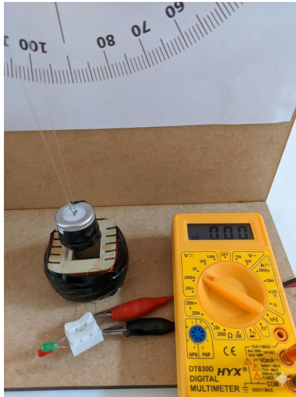
Figura 5. Bobina conectada ao multímetro. (Autor, 2025).
