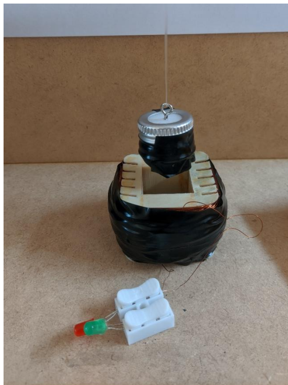
Figura 3. Bobina em curto-circuito. (Autor, 2025)
