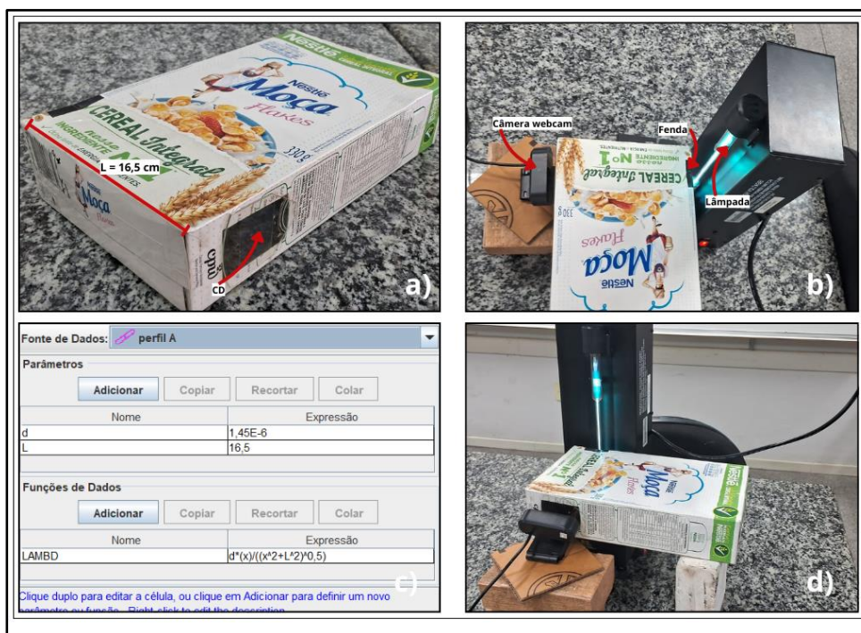
Figura 2 - Espectrômetro 1. Onde: a) Estrutura externa mostrando o posicionamento do CD; b) Configuração experimental do sistema, mostrando a lâmpada espectral posicionada diante da fenda, a câmera webcam e o CD à frente da câmera; c) Interface do software Tracker utilizada na análise dos dados, com destaque para os parâmetros inseridos e a expressão para a determinação do comprimento de onda; d) Vista frontal do arranjo experimental. Fonte: os autores.
