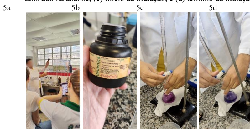
Figura 5 – Realização de análises químicas da água: (a) Realização de análise de dureza da água; (b) Indicador utilizado na análise; (c) Início da titulação; e (d) término da titulação
