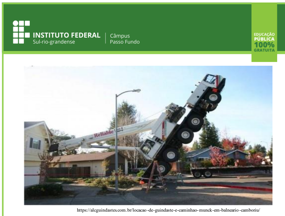
Figura 5. Acidente com guindaste
