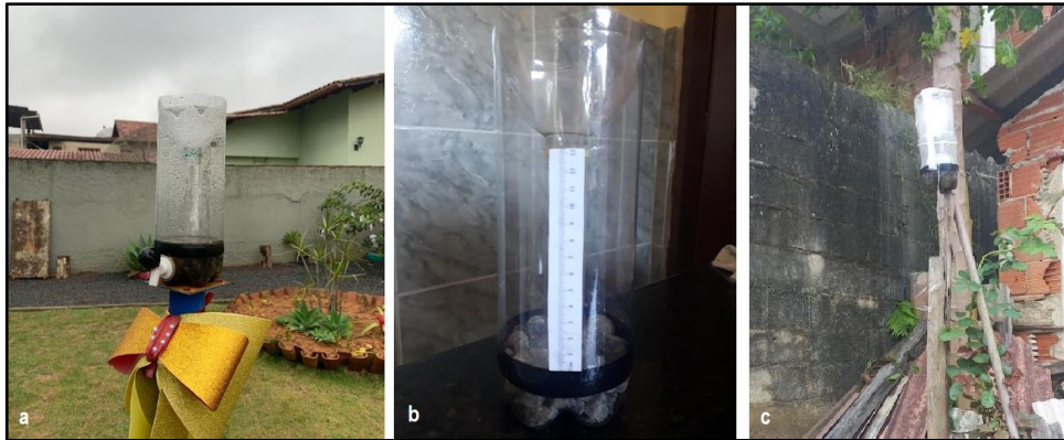
Figura 2: Da esquerda para direita temos o pluviômetro feito e instalado na escola (a), um pluviômetro feito por um dos estudantes (b) e a instalação de um pluviômetro na residência de um dos estudantes (c).
