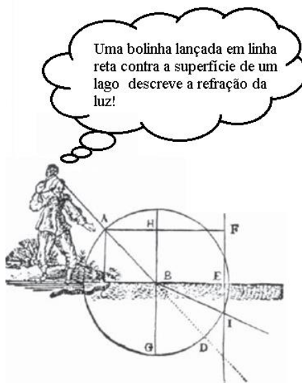
Figura 1: Neste momento Descartes apresenta alguns princípios que deverão ser considerados para o cálculo da refração da luz. São eles: propagação retilínea da luz; independência dos raios de luz e o princípio do menor caminho percorrido pela luz. Modificado de Démarches Originales de Descartes Savant Pierre Costabel, 1982.
