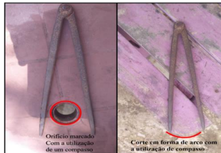
Figura 11 - O uso do compasso na realização de furos e corte curvados Fonte: Autoria própria
