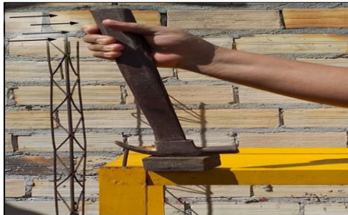
Figura 6 - Ponto de apoio para retirada do prego com facilidade Fonte: Autoria própria
