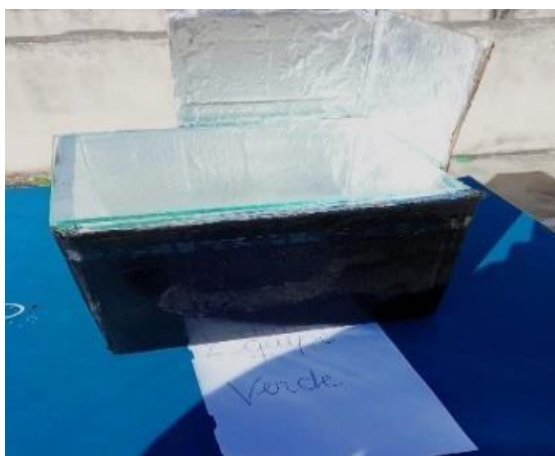
Figura 4. Registro fotográfico do protótipo de forno solar construído pela equipe verde. Fonte: elaboração própria, 2022.
