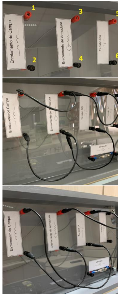
Figura 4: (a) Bornes relativos ao enrolamento de campo, enrolamento de armadura e da fonte de corrente contínua. (b) Conexão paralela e (c) série dos enrolamentos da armadura e de campo alimentados pela fonte de corrente contínua.
