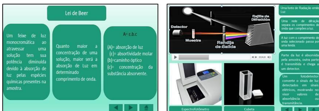
Figura 13: Abordagem da Lei de Beer (imagem à esquerda) e Simulação do funcionamento de um espectrofotômetro (imagem à direita).
