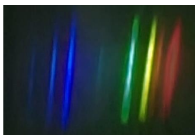
Figura 10: Espectro de emissão de uma lâmpada de vapor de mercúrio em alta pressão.
