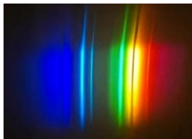
Figura 8: Espectro de emissão de uma lâmpada de vapor de sódio em alta pressão.
