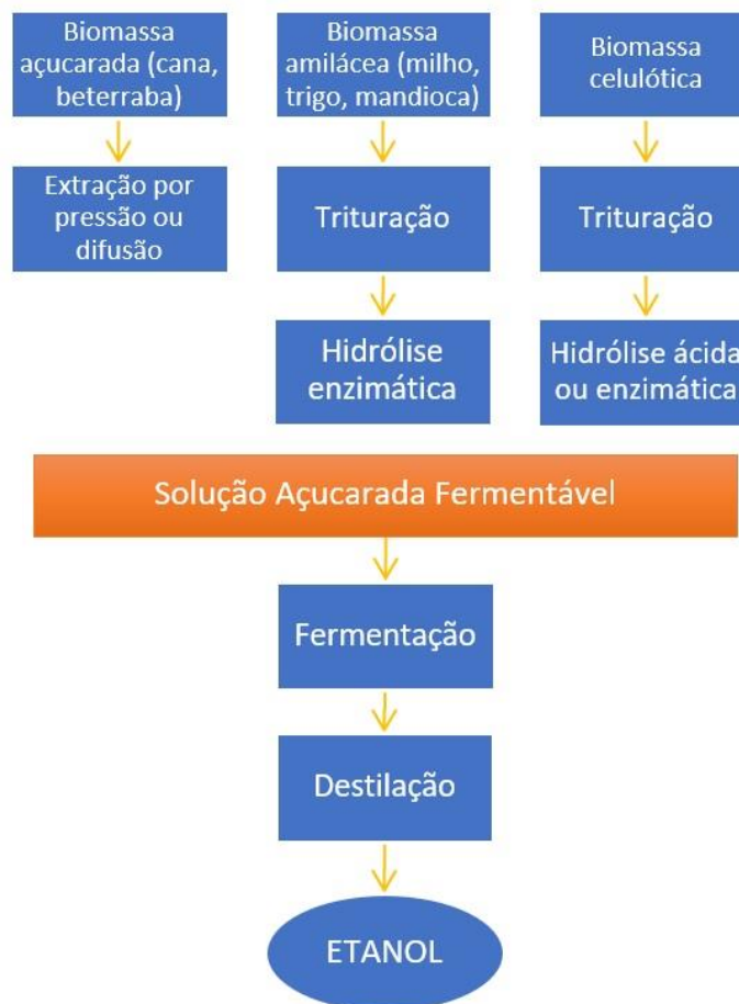
Figura 76 – Esquema das vias de extração de três diferentes biomassas (açúcar, amido e celulose) para obtenção de etanol. Fonte: as autoras
