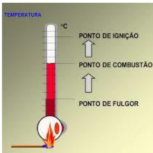
Figura 75 – Representação dos pontos de fulgor, combustão e ignição em relação a temperatura.
