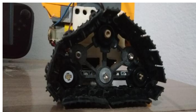
Figura 14: Esteiras do tipo lagarta. Fonte: Próprio autor.
