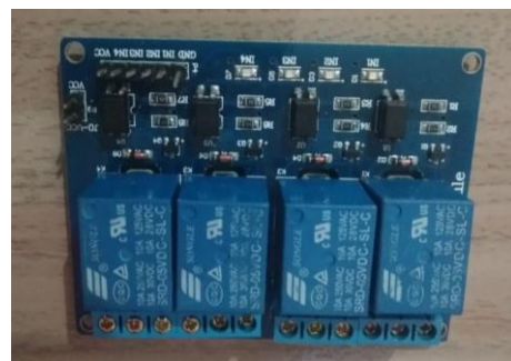
Figura 18b – Modulo rele. Fonte: Próprio autor.
