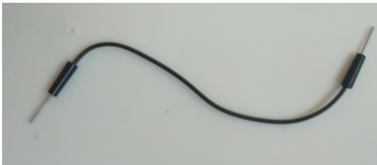
Figura 20a: Cabo jumper. Fonte: Próprio autor.
