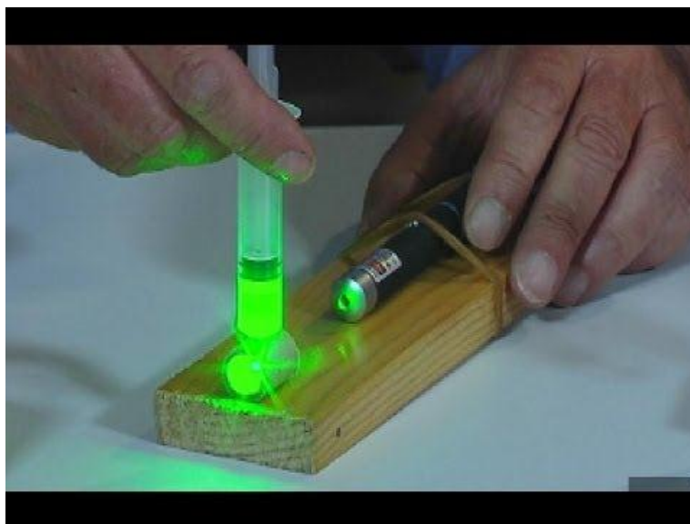
Figura 24: Microscópio alternativo feito com luz verde.
