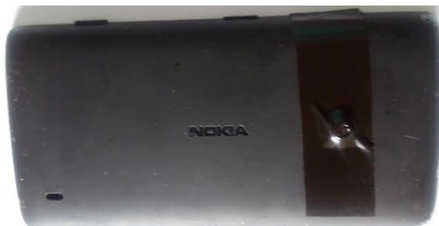
Figura 28: Microscópio alternativo usando um celular com câmara e lente de leitor de CD.
