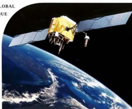
IMAGEM DO SATÉLITE NAVSTAR 2F UTILIZADO POR APARELHOS DE GPS PARA INFORMAR A LOCALIZAÇÃO. FONTE: NASA
