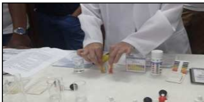
Figura 19: Teste de pH com fitas indicadoras. Fonte: A autora.
