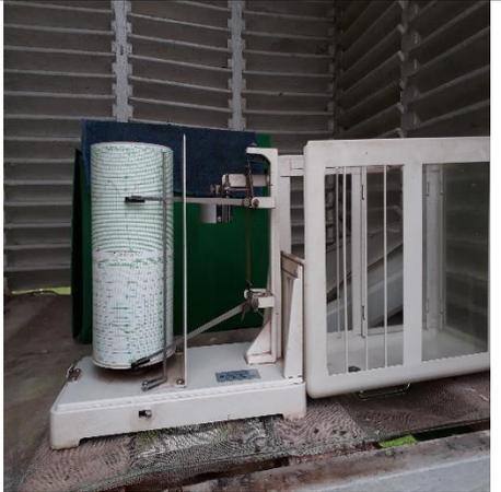
Termógrafo com um cilindro de registro rotatório para registrar a temperatura do ar.                                          | <p>Termógrafos registra a temperatura do ar, em graus Celsius (<math>^{\circ}\text{C}</math>).</p>                                       |
