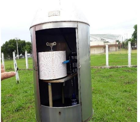
Pluviômetro universal com um cilindro metálico e uma tampa conical para medir a precipitação pluvial.                           | <p>Pluviômetro universal mede a quantidade de precipitação pluvial (chuva), em milímetros (mm).</p>                                      |
