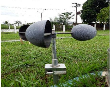
Anemômetro com dois globos esféricos para medir a velocidade e direção do vento.                                                | <p>O Anemômetro mede a velocidade do vento (em m/s) e, em alguns tipos, também a direção (em graus).</p>                                 |
