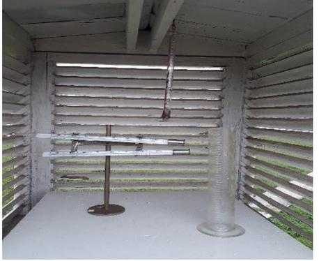
Termômetros de Máxima e Mínima instalados em um gabinete de proteção para registrar as temperaturas máximas e mínimas do dia. | <p>Termômetros de Máxima e Mínima - indicam as temperaturas máxima e mínima do ar (<math>^{\circ}\text{C}</math>), ocorridas no dia.</p> |
