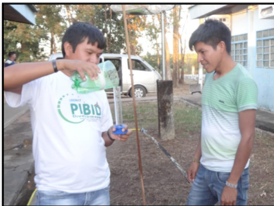
Figura 13 – Determinação da Altura Pluviométrica
