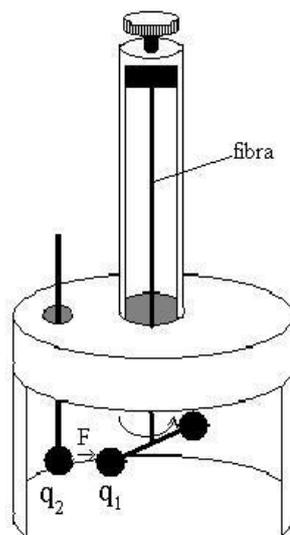
Figura 8 - Balança de Torção - Fonte: [https://pt.wikibooks.org/wiki/Eletromagnetismo/Cargas\\_el%C3%A9tricas](https://pt.wikibooks.org/wiki/Eletromagnetismo/Cargas_el%C3%A9tricas)
