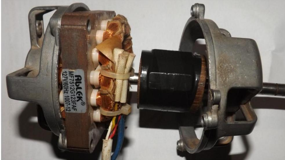
Figura 39 - Colocando o rotor no estator.
