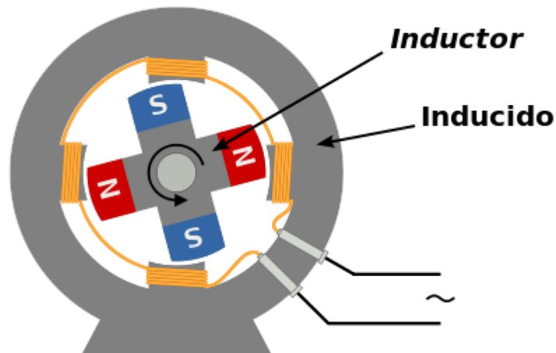
Figura 15 - Esquema de um alternador - Fonte: <https://commons.wikimedia.org/wiki/File:Alternador.svg>
