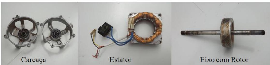
Figura 35 - Partes do motor de ventilador
