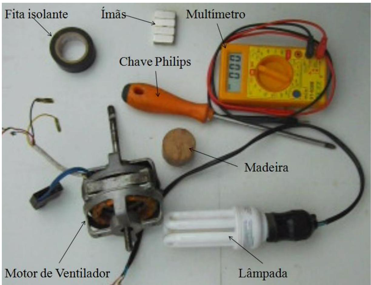
Figura 30 - Materiais para construção e teste do gerador
