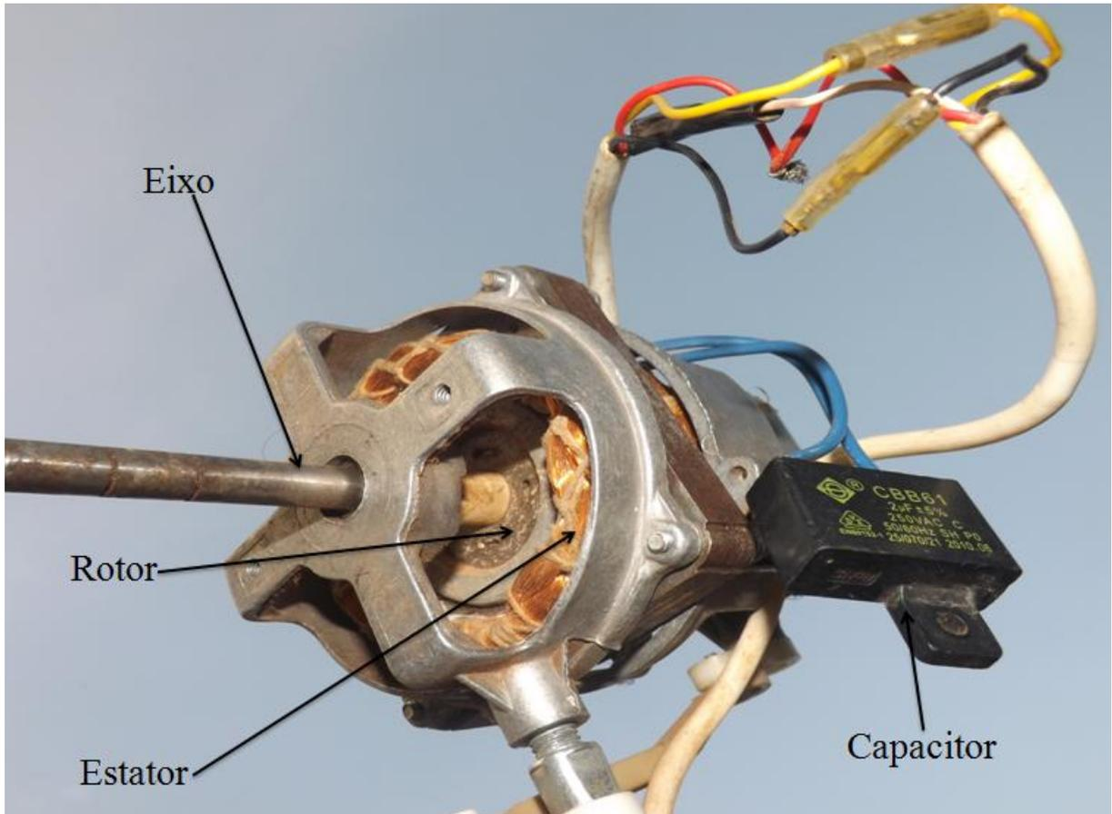
Figura 31 - Partes do motor de ventilador
