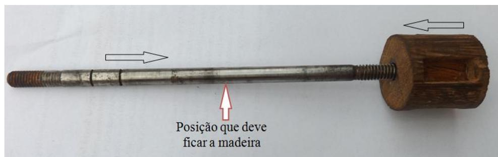
Figura 36 - Esquema de montagem do rotor
