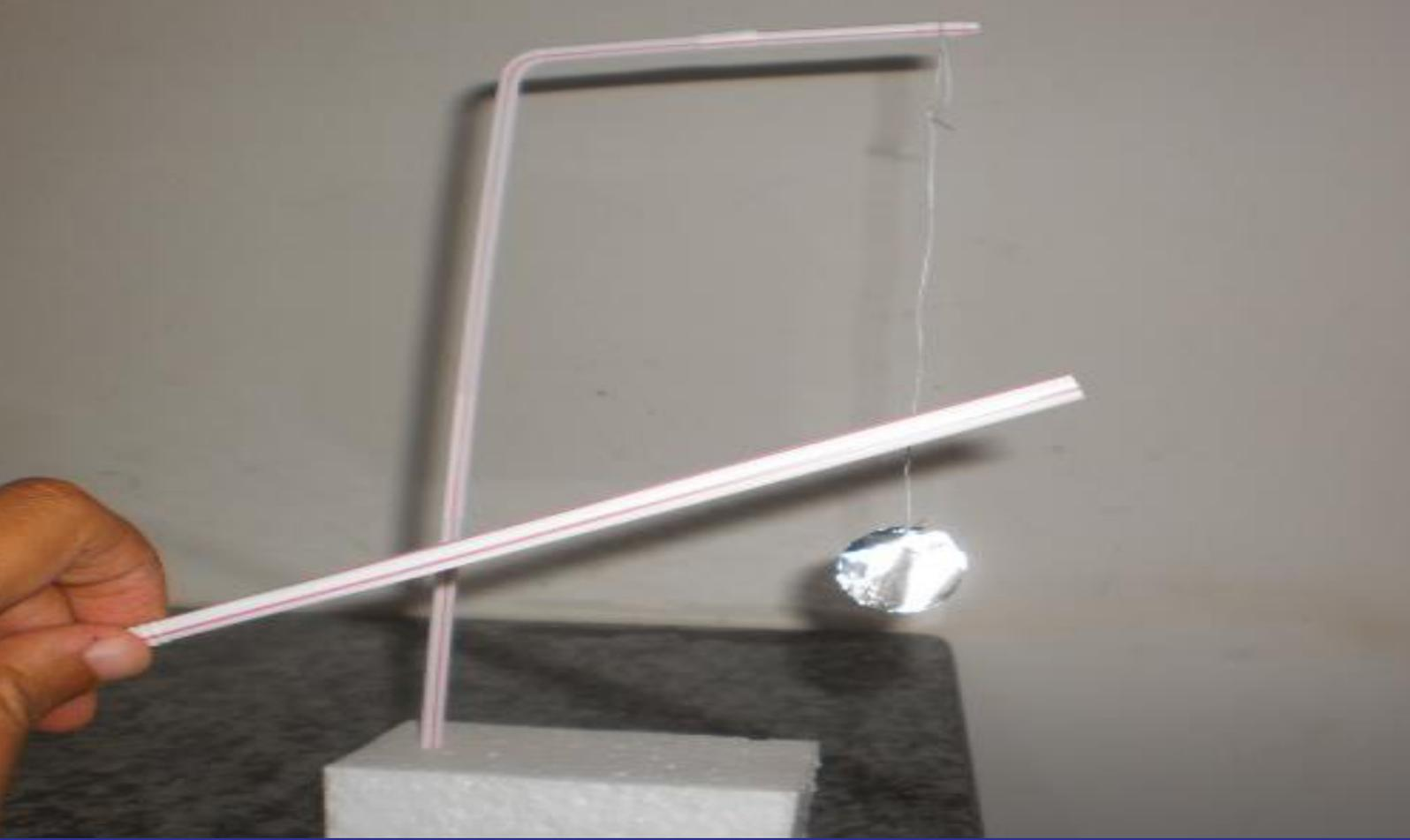
Alguns conceitos observáveis: Processos de eletrização, Carga elétrica, Força eletrostática, Campo elétrico.
