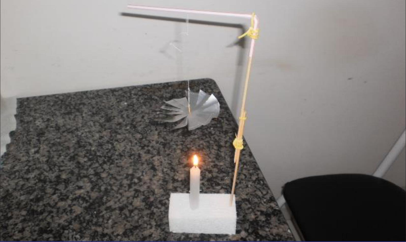
Alguns conceitos observáveis: Convecção térmica, densidade, rotação pressão e forças de interação.
