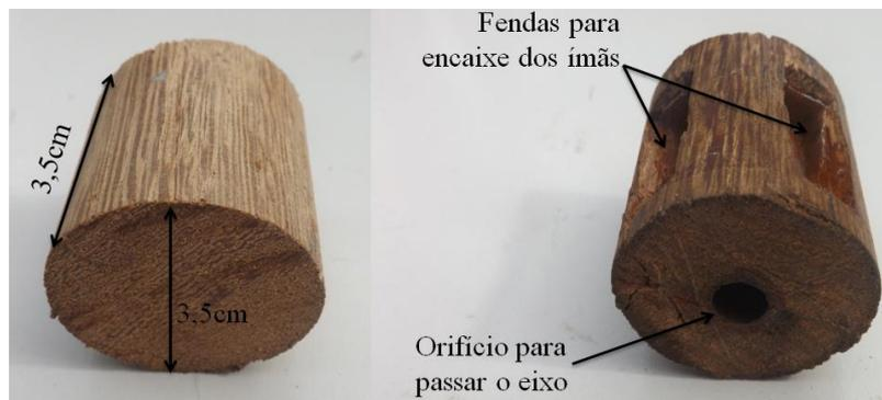
Figura 33 - Madeira que servirá de suporte aos ímãs do rotor
