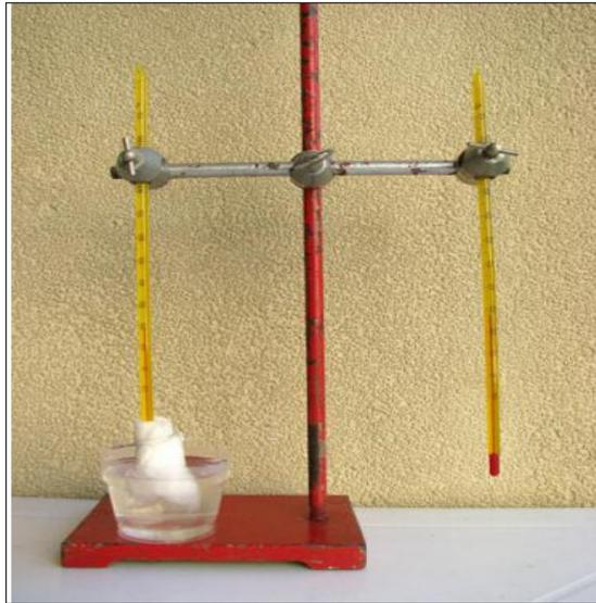
Figura 05 - Psicrômetro montado.
