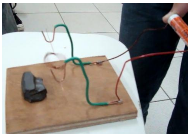
Foto 23 - Princípio de funcionamento dos motores elétricos.
