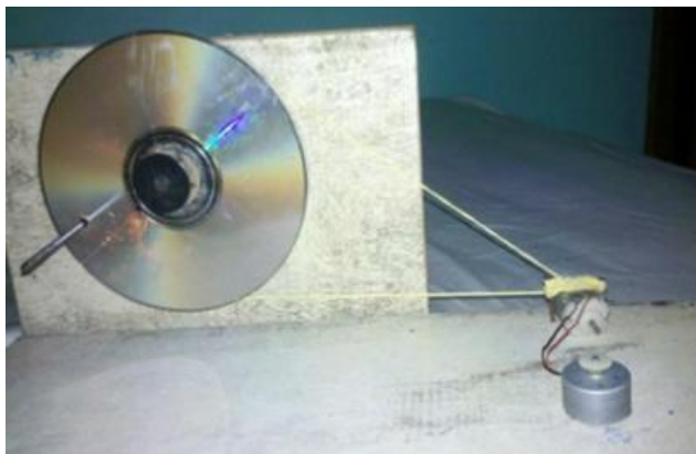
Foto 19- Princípio de Gerador elétrico.
