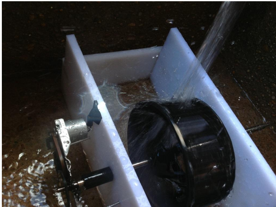
Figura 7 - Protótipo em funcionamento pode-se perceber a luz LED ligada.
