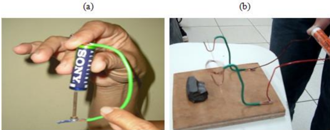
Foto 17 (a) e (b) – Princípio de funcionamento dos motores elétricos.
